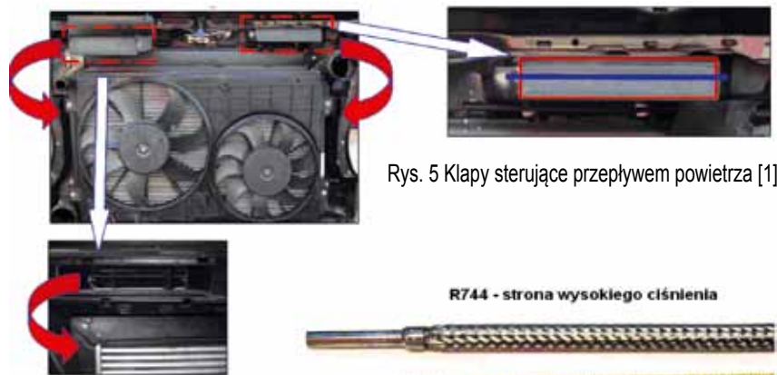
Rys. 6 Przewody wysokiego ciśnienia dla R 134a (gumowy) i dwutlenku węgla (odporny na wysokie ciśnienie), [3]
