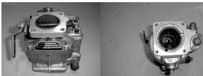
Rys. 19. Gaźnik typu Marvel – Schebler, widoczna przepustnica oraz zespół dysz wraz z rozpylaczem paliwa
