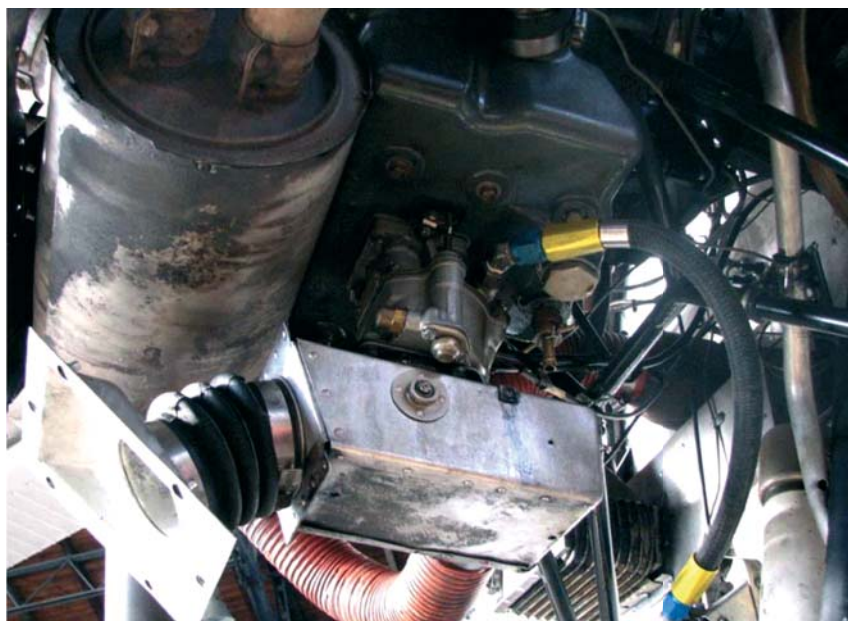
Rys. 21. Zabudowa i szczegóły konstrukcyjne gaźnika typu Marvel na silniku Lycoming
