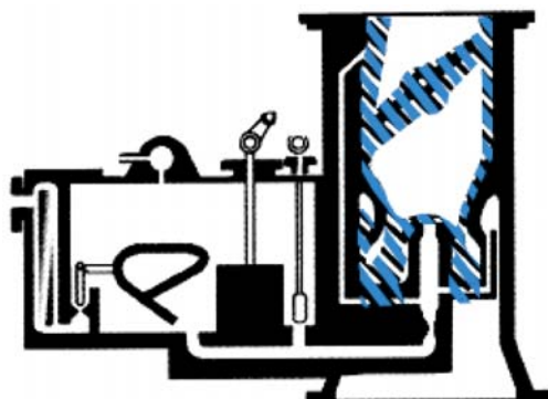
Rys. 20. Schemat gaźnika Marvel z zaznaczonymi miejscami osadzania się lodu [9]
