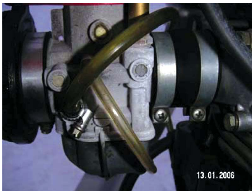
Rys. 15. Korpus gaźnika lekkiego silnika lotniczego pokryty warstwą szronu
