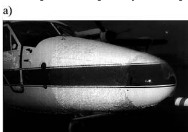
Rys. 6. Oblodzenie kadłuba (a) [8] oraz krawędzi natarcia skrzydła (b) [9] – lód szklisty; na zdjęciu fragmentu skrzydła widoczne jest proste urządzenie do wizualnej oceny grubości warstwy lodu i szybkości jego narastania
