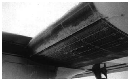
Rys. 8. Oblodzenie dolnej powierzchni skrzydła poza zasięgiem instalacji odladzającej - szadz [8]
