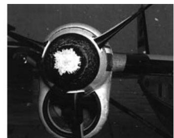
Rys. 9. Lód na niechronionym kołpaku śmigła [8]
