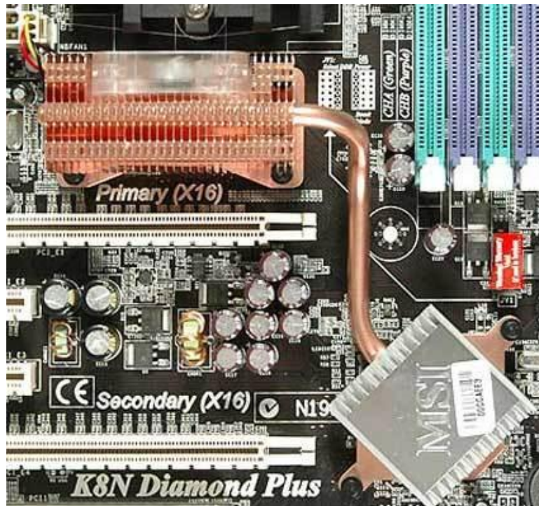
Rys. 17. Montaż rurki ciepła na komputerowej płycie głównej [ 11]
