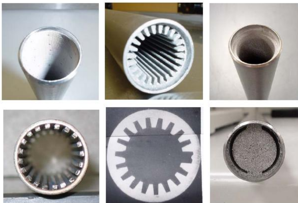
Rys. 7b. Przekroje poprzeczne różnych rodzajów rurek ciepła z przedstawioną strukturą knota, wg [4].
