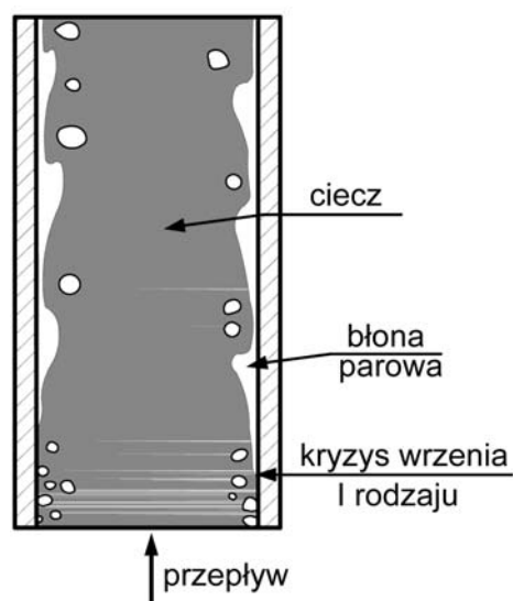
Rys. 1. Odwrócony przepływ pierścieniowy – kryzys wrzenia I rodzaju
