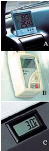
Rys. 11. Dodatkowe moduły pomiarowe pojemnika izotermicznego firmy Waeco Cool [6]: A – moduł do pomiaru temperatury i ciśnienia panujących w pojeździe, B – moduł do pomiaru ciśnienia perfuzyjnego, C – moduł do pomiaru temperatury wewnątrz i na zewnątrz pojemnika
