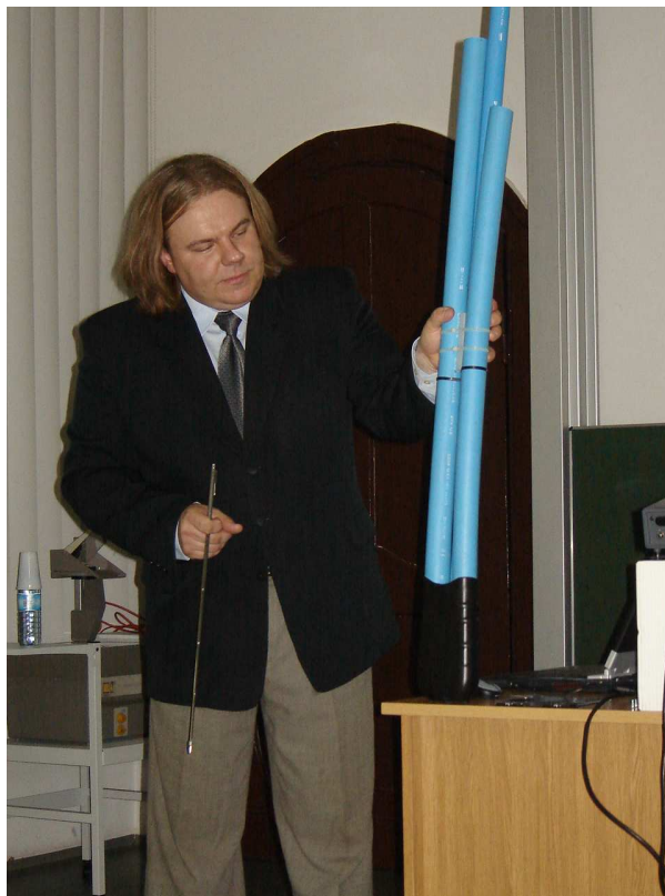
Fot. 3. Pośród wielu eksponatów znalazło się zakończenie gruntowego pionowego wymiennika ciepła
