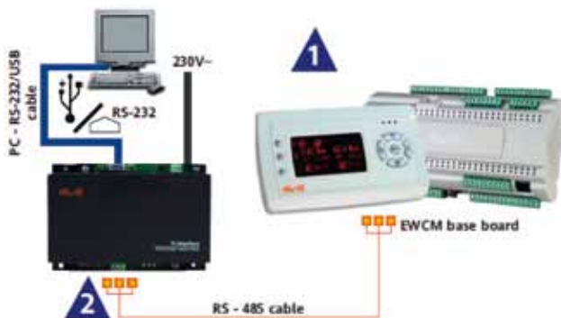
Fot. 5. Internet, elektronika i komputery na dobre zagościły w technice chłodniczej i klimatyzacyjnej – dzięki oprogramowaniu Televis można łączyć regulatory i sterowniki w szersze układy zarządzania i zdalnego nadzoru nad pracą nawet bardzo rozbudowanych instalacji
